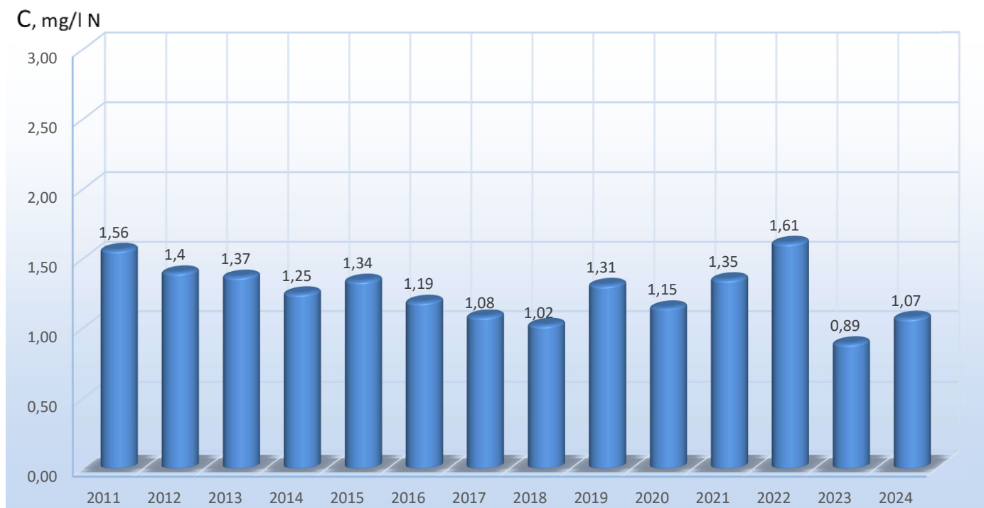
27 pav. Vidutinės metų nitratų ( \text{NO}_3\text{-N} ) koncentracijos kitimas Prūdelio tvenkinyje 2011 ÷ 2024 m.
