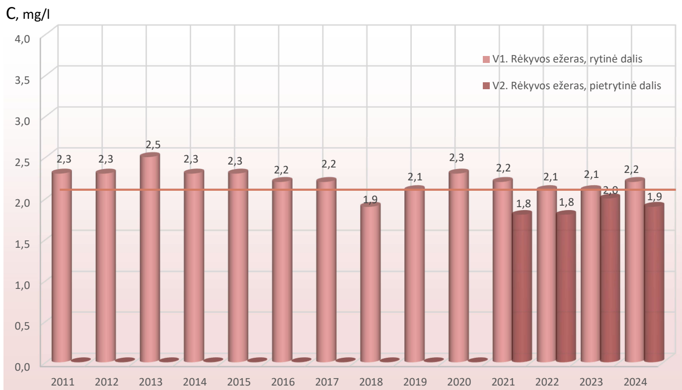
47 pav. Bendrojo azoto ( N_b ) vidutinės metų koncentracijos kitimas Rėkyvos ežere 2011÷ 2024 m.
