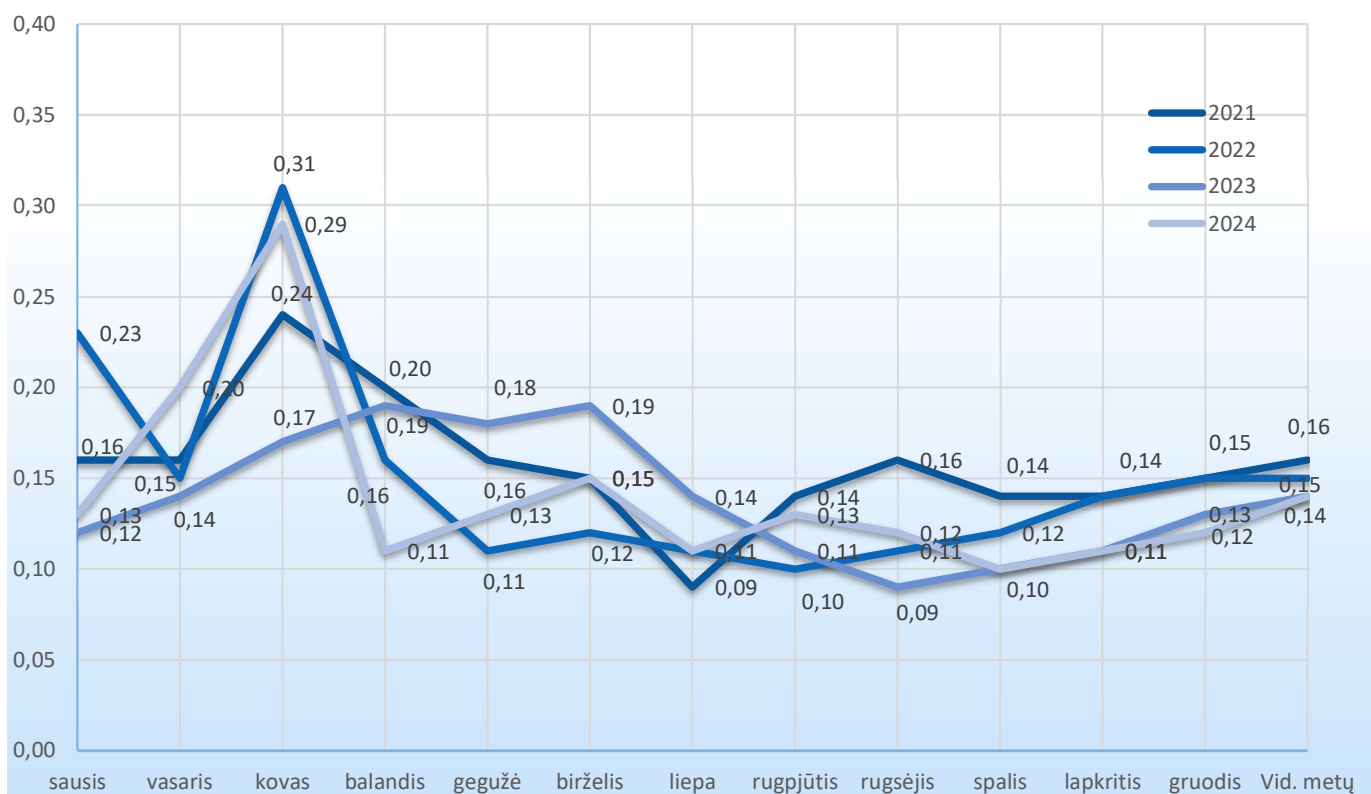
22 pav. Nitratų ( \text{NO}_3\text{-N} ) koncentracijos sezoninis kitimas Rėkyvos ežere 2021 ÷ 2024 m.
